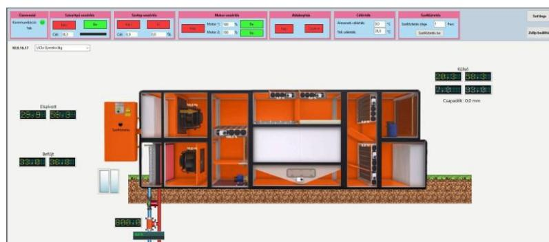
Grazie a questo sistema è possibile controllare il funzionamento degli impianti di climatizzazione e riscaldamento al fine di ottenere il massimo risparmio energetico.
